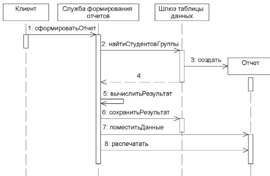
Рис. 5. Формирование отчета в системе, построенной на базе паттерна «сценарий транзакций»
